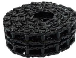
Wir haben ein komplettes Sortiment an Stahlketten im Angebot. Passend für alle gängigen Bagger und kettenbetriebene Maschinen von 101mm bis 260mm Kettenteilung. Alle Stahlketten für Bagger sind fettgeschmiert und versiegelt für maximale Laufzeiten. Polyurethan-Dichtungen ermöglichen bessere Laufruhe und verhindern das Eindringen abrasiver Stoffe in Bolzen und Buchsen. Dadurch werden Abnutzungen reduziert.
